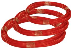
PTFE-Kunststoffschlauch ist resistent gegen Lösungsmittel und aggressive Chemikalien. Feuchtigkeit u. UV-Strahlung verursachen weder eine Volumenänderung noch Verwitterung und Versprödung. PTFE ist kältebeständig bis -200°C und ist dauerwärmebeständig bis +260°C.
